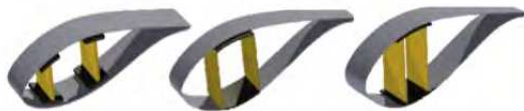
Figura SEQ Figura \* ARABIC 3: Celdas con: a) refuerzos estructurales. b) un solo refuerzo superficial tipo caja. c) refuerzo superficial entre webs.
