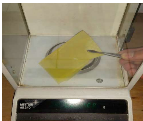
Figura 1: Pesaje de muestra plegada antes del tratamiento de exposición a intemperie.
