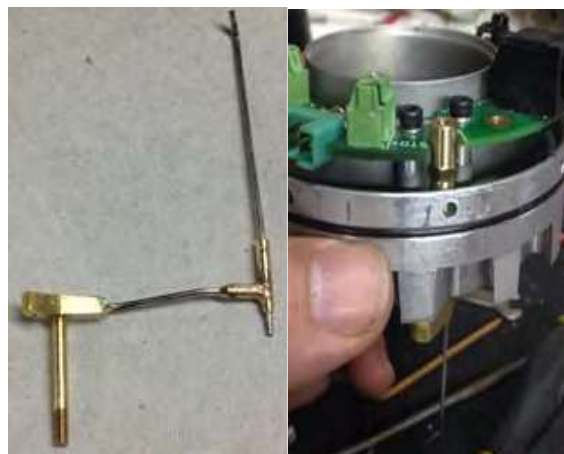
Figura 4: Nueva cañería de lubricación y montaje.
