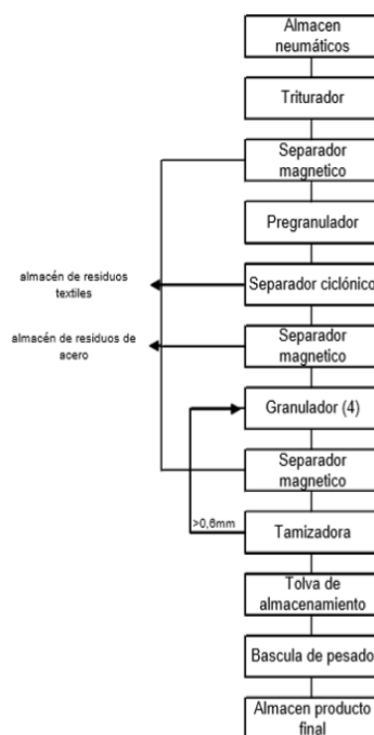
Figura 2: Layout general de una planta integral de trituración de NFU
