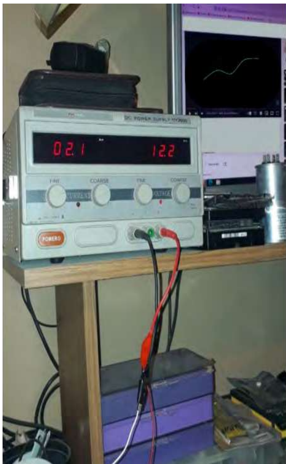
Figura 5: Tensión y Corriente de Trabajo del Gabinete
