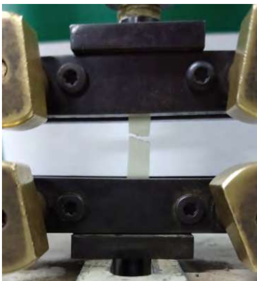
Figura 3: Muestra de polietileno con aditivo oxodegradante expuesta a intemperie luego del ensayo de tracción.
