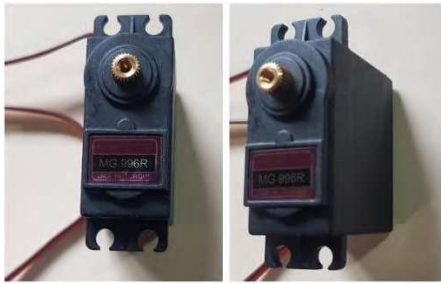
Figura 9 Servomotor utilizado en el cabezal de la impresora Braille.
