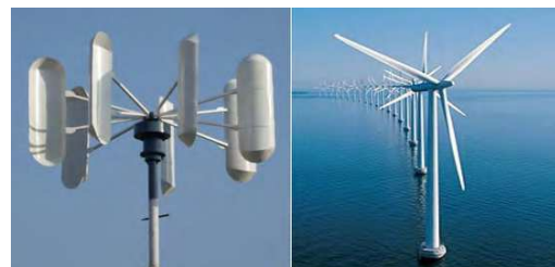
Figura 1: Aerogenerador de eje vertical y eje horizontal [12],[13].
