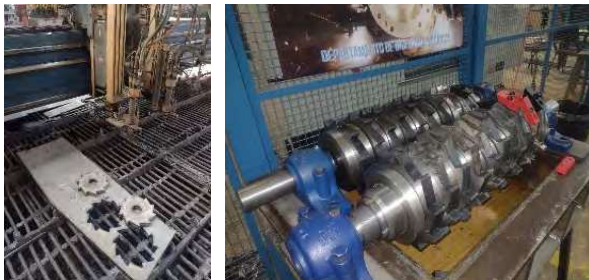
Figura 5: Mecanizado en control numérico del prototipo de trituradora.
