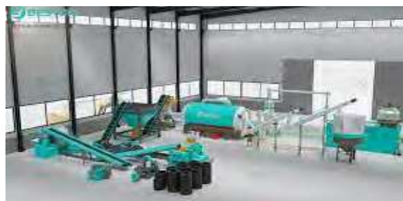
Figura 3: Vista 3D de una planta integral de trituración de NFU
