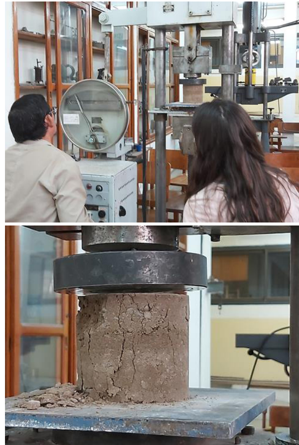
Figura 3: Determinación de la resistencia a la compresión axial no confinada.
