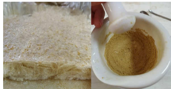
Figura 1: Extracto liofilizado de yerba mate antes (izquierda) y después (derecha) de ser molido.
