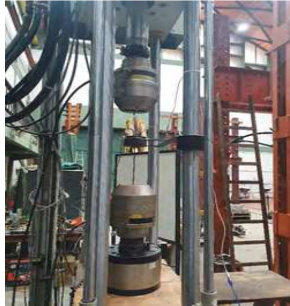
Figura 2: Equipo Instron con acelerómetros colocados.
