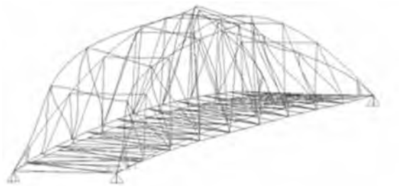
Fig. 15. Sexto Modo de Vibración (Modo 6) – Perspectiva.
