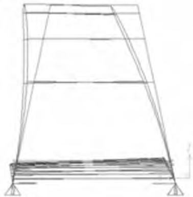
Fig. 10. Modo Fundamental de Vibración (Modo 1) – Vista transversal.
