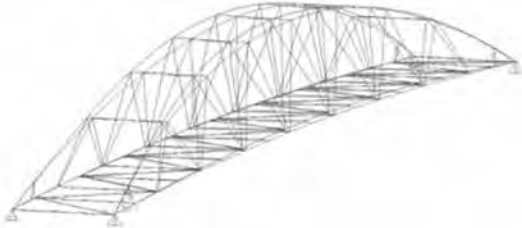
Fig. 9. Modo Fundamental de Vibración (Modo 1) – Estructura Completa
