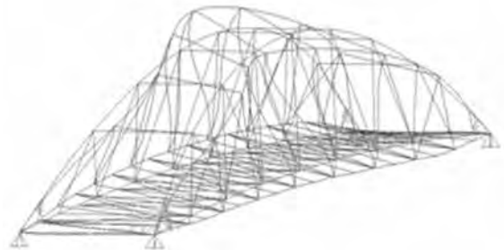
Fig. 14. Quinto Modo de Vibración (Modo 5) – Perspectiva
